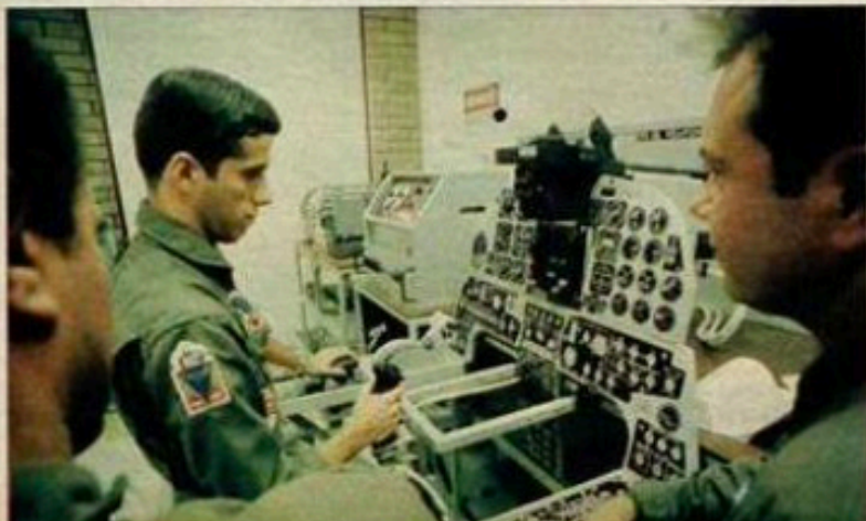
Diante de um painel eletrônico, que reproduz exatamente o F5E, os oficiais brasileiros são submetidos a exaustivos testes que simulam as diversas condições de vôo e de combate.
